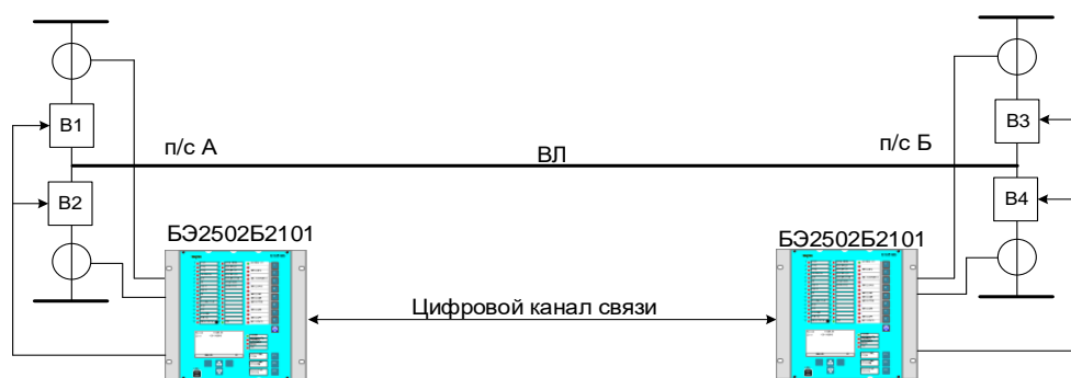
Рисунок 1 – Принцип действия ДЗЛ
